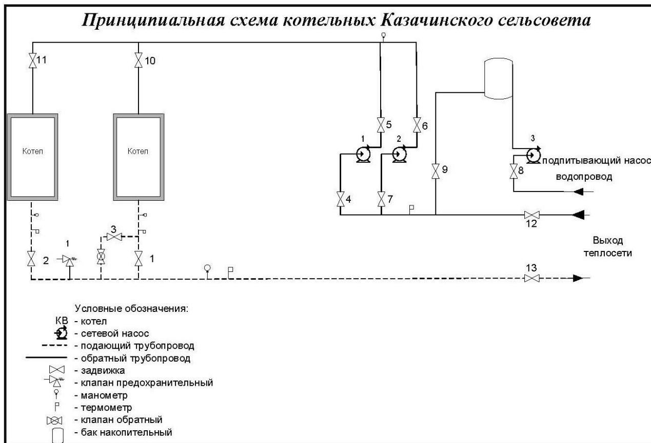
Рисунок 1.2.6.1 – Принципиальная тепловая схема котельной с водогрейными котлами
