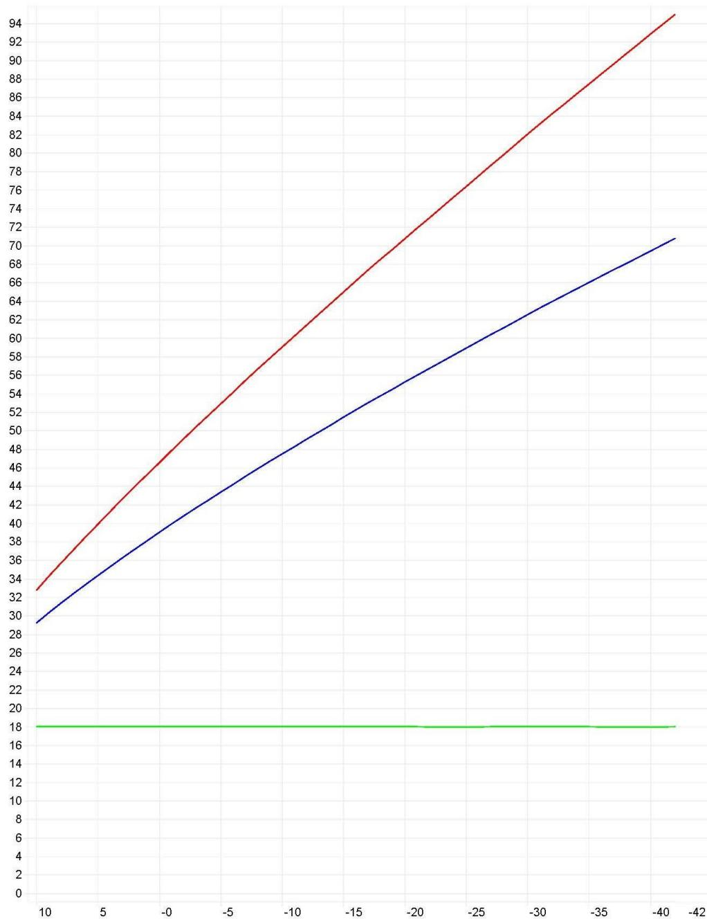
*Рисунок 5.8.1 – Расчет отпуска тепловой энергии для котельной Детловского сельсовета Курагинского района Красноярского края в течение года при температурном графике 95-70 °С*
